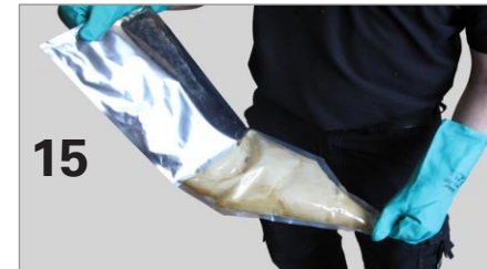
15 Das dunkle Isocyanat in das klare Polyol drücken. Die Schaumtüten schütteln, bis die Flüssigkeit eine einheitliche hellbraune Farbe ohne dunkle Flecken angenommen hat.
