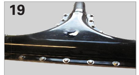
19 Wenn die Halbschale mit Schaum gefüllt ist und der Schaum mindestens 20 Minuten ausgehärtet ist, muss der Entlüftungsstopfen und der ausgetretene Schaum entfernt werden.
