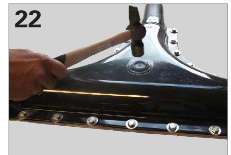
22 Expansionskegel in den Expansionsstopfen einschlagen.
